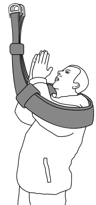
Einstieg bei geschlossener Rettungsschlinge
